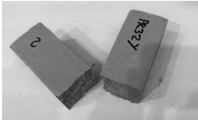
Figura 28. Muestra de ladrillo después del ensayo de flexión
