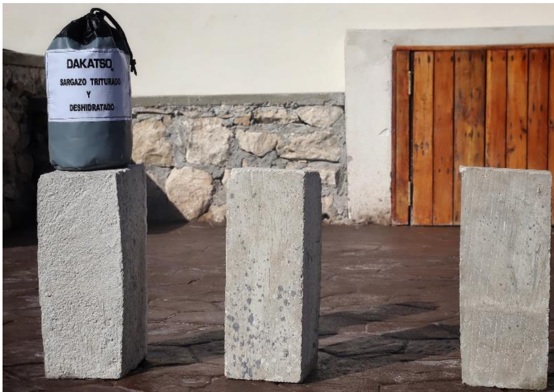
Figura 40. Bloques de concreto con Sargazo
