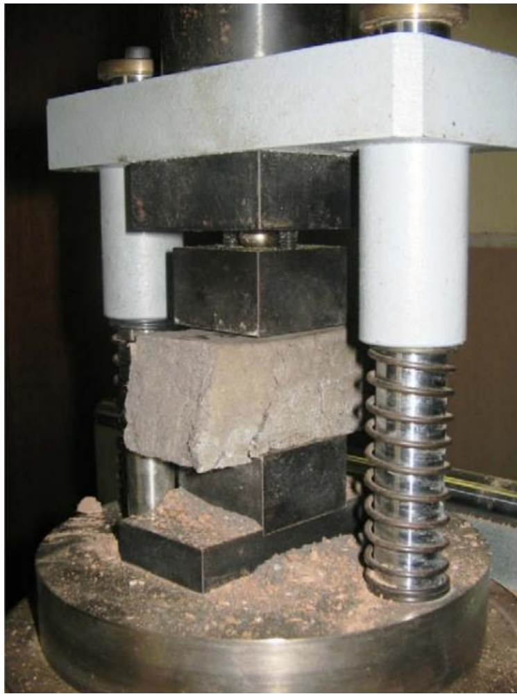
Figura 27. Muestra bajo prueba de compresión.
