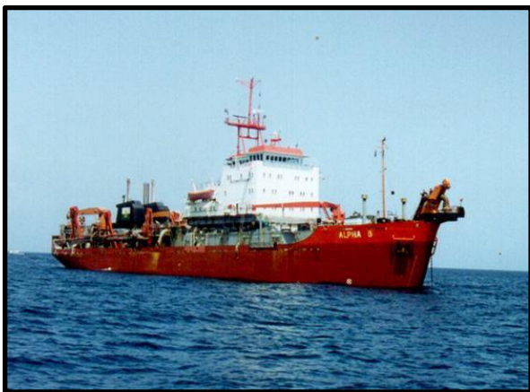
Fotos 3 y 4. Proyecto de Alimentación Artificial de Arena Varadero 1998. Dragas de succión en marcha Alpha- B de la empresa holandesa BLANEVOORT.
