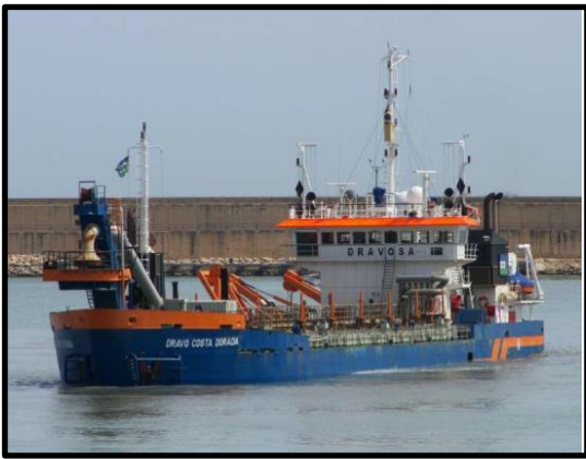
Fotos 5 y 6. Proyecto de Alimentación Artificial de Arena Varadero 2012. Draga de succión en marcha Dravo Costa Dorada de la empresa holandesa Van Oord.
