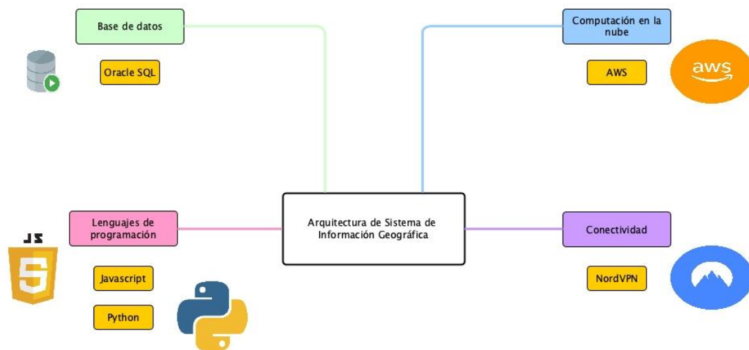
Figura 29. Arquitectura interna de SIG – Sistema de alerta temprana de sargazo.
