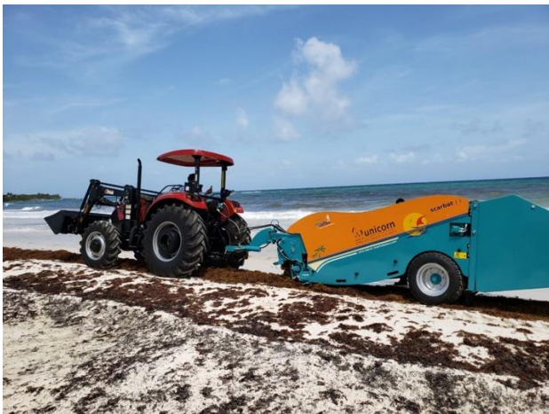
Figura 6. Unicorn Scarbat 1.5, Maquina Limpiadora de sargazo en República Dominicana.
